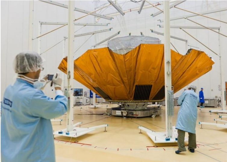
Abb. 1: Der über 10 Meter große Sonnenschirm des Weltraumobservatoriums Gaia bei einem Probelauf des Ausfaltvorgangs in der Montagehalle. Hier ist die goldfarbene, im Betrieb zur Sonne und Erde gerichtete Unterseite gut erkennbar.
