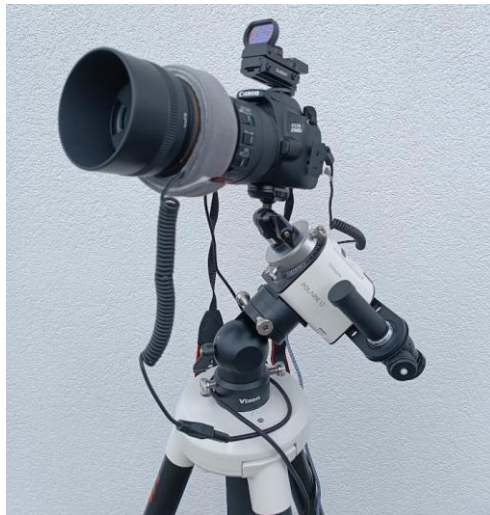
Abbildung 2: Das Foto-Setup, bestehend aus einer Kamera Canon EOS 250D mit Makroobjektiv Sigma 105 mm, Heizband, Kugelkopf, Star Tracker mit Polsucher, sowie Stativ mit Feineinstellung. Betrieben wurden die Geräte über zwei Akkus.
