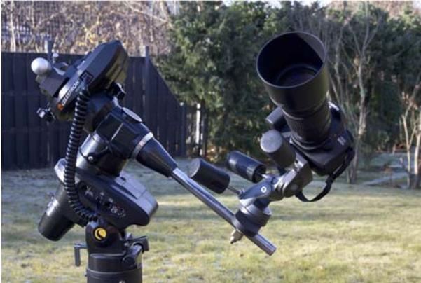
Abbildung 1: Canon EOS 60Da mit EF 200mm f/2.8L auf einem 3D-Neigeckopf an der Deklinationsschne einer parallaktischen Montierung mit motorischer Nachführung.
