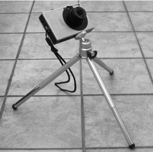
Abbildung 1) Canon IXUS 70 auf Ministativ: Mit dieser handlichen Kombination wurden die meisten Aufnahmen für die Beispiellichtkurven gewonnen. Für die gewählte Belichtungszeit von 15 Sekunden ist keine Nachführung erforderlich. Die Kombination ist immer dabei und in Sekunden aufnahmebereit. Das Gesamtgewicht beträgt nur 230 Gramm. Eine ideale Reisesternwarte...
